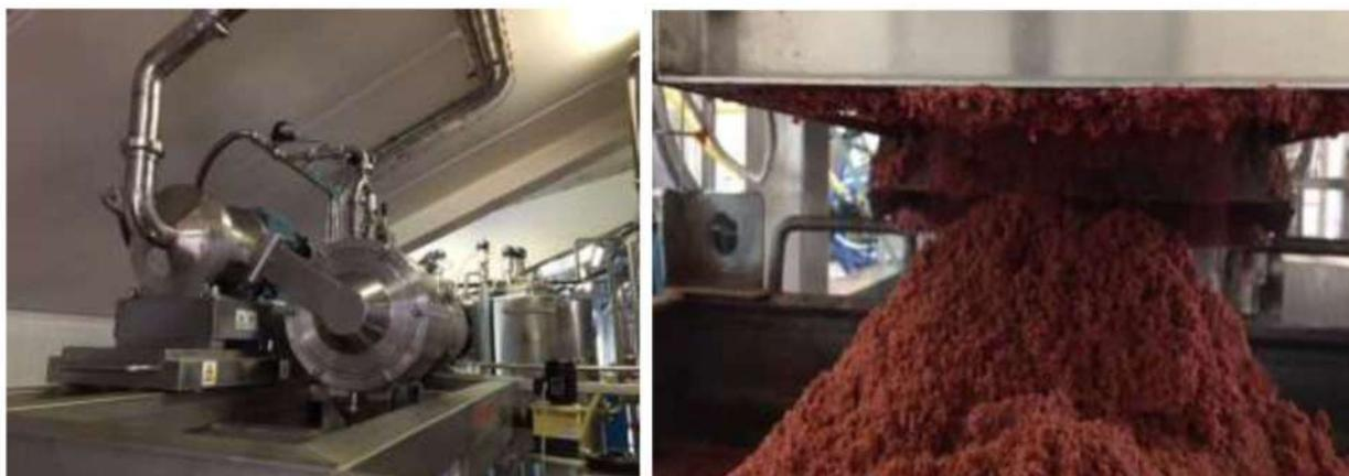
*Tubo estrattore e raccolta scarti di lampone*
